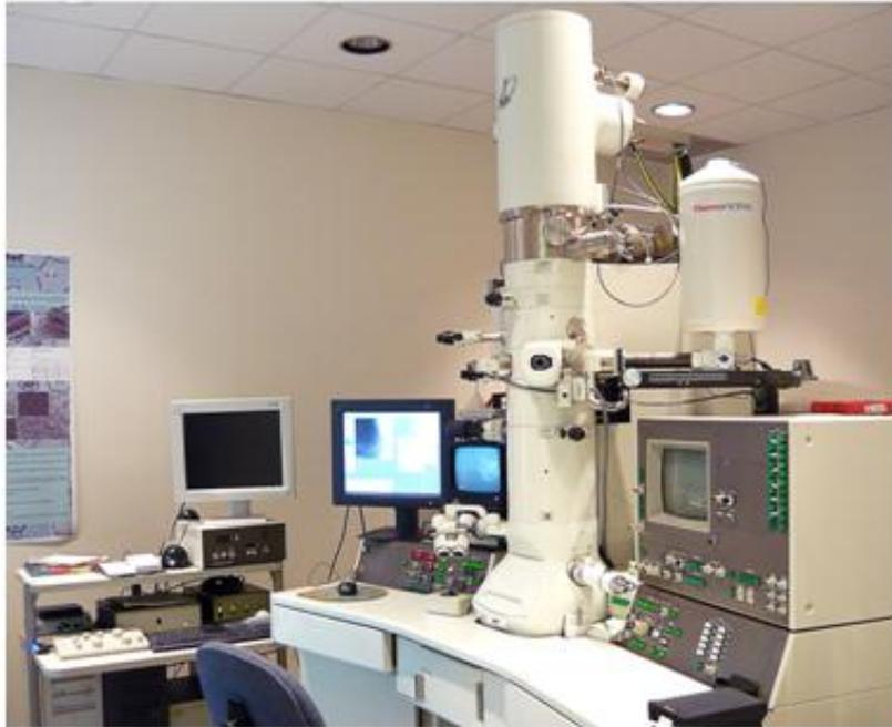
Figura 2.2.1. Microscopio Electrónico de Transmisión JEOL JEM-2010F Instituto de Física, UNAM
