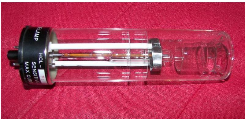
**Figura 3.9 Lámpara de cátodo hueco**
