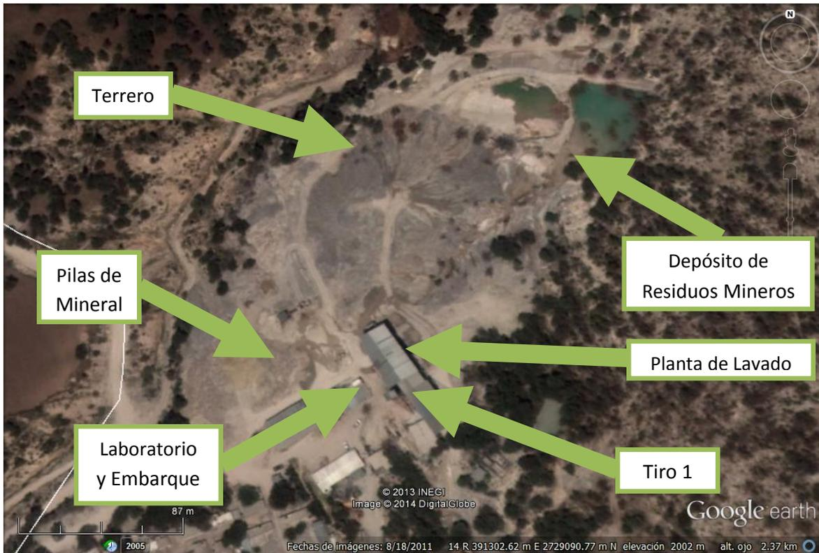
Figura 7.5 Instalaciones relacionadas con el procedimiento de concentración mineral. <sup>[20]</sup>
