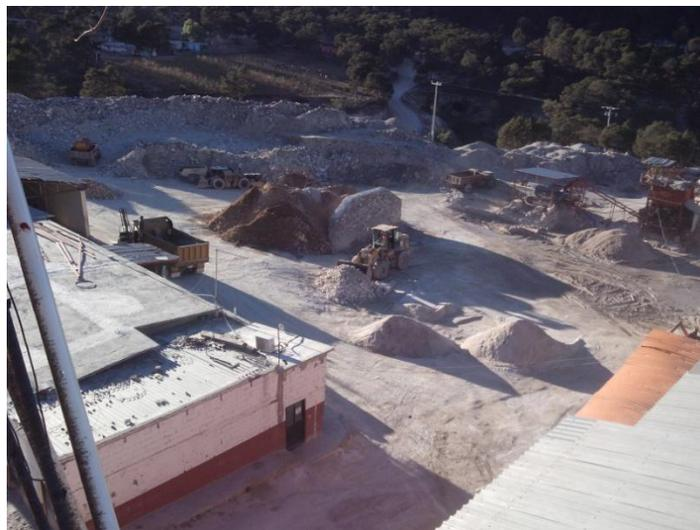
Figura 7.4 Patio de almacenamiento en pilas de mineral.
