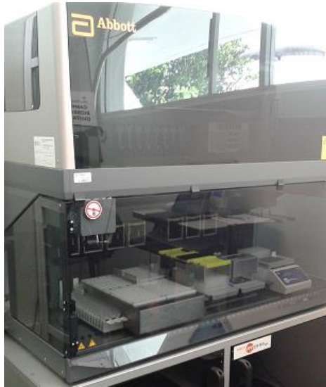
Figura 8. Sistema Abbott m2000sp™ para RT-PCR Multiplex en tiempo real
