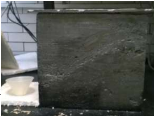
Figura 2.3.1.2. Blindaje del detector y a su izquierda, entrada de depósito de N 2 líquido
