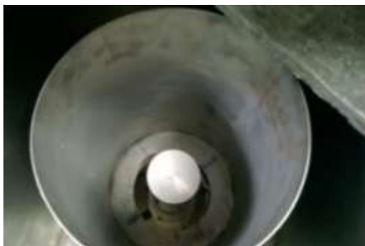
Figura 2.3.1.3. Detector, lugar donde se coloca el contenedor Marinelli. Dentro del blindaje.
