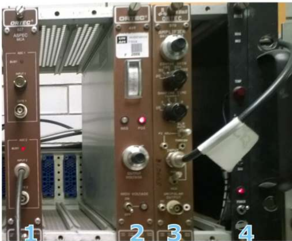
Figura 2.3.2.2. Cara frontal de instrumentación: 1) Analizador MCA 2) Fuente de alto voltaje 3) Amplificador 4) Fuente de poder
