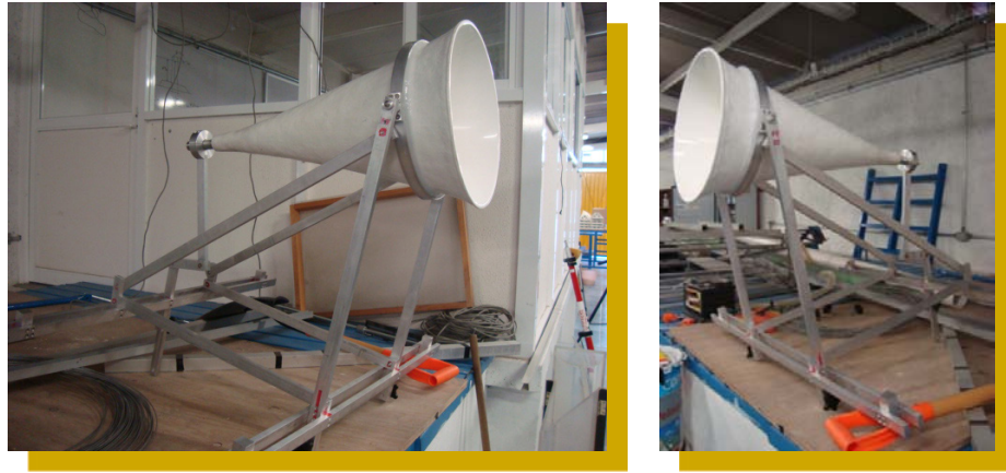
Figura 25. Soportería del Blowjet .
