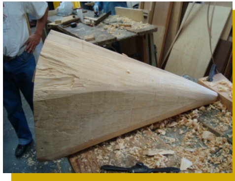
Figura 21. Construcción del Blowjet .
