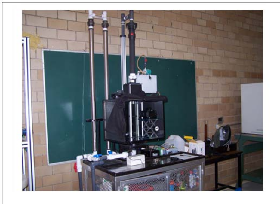
Fig. 2.9-3 Montaje de una cámara oscura para la visualización de vórtices.
