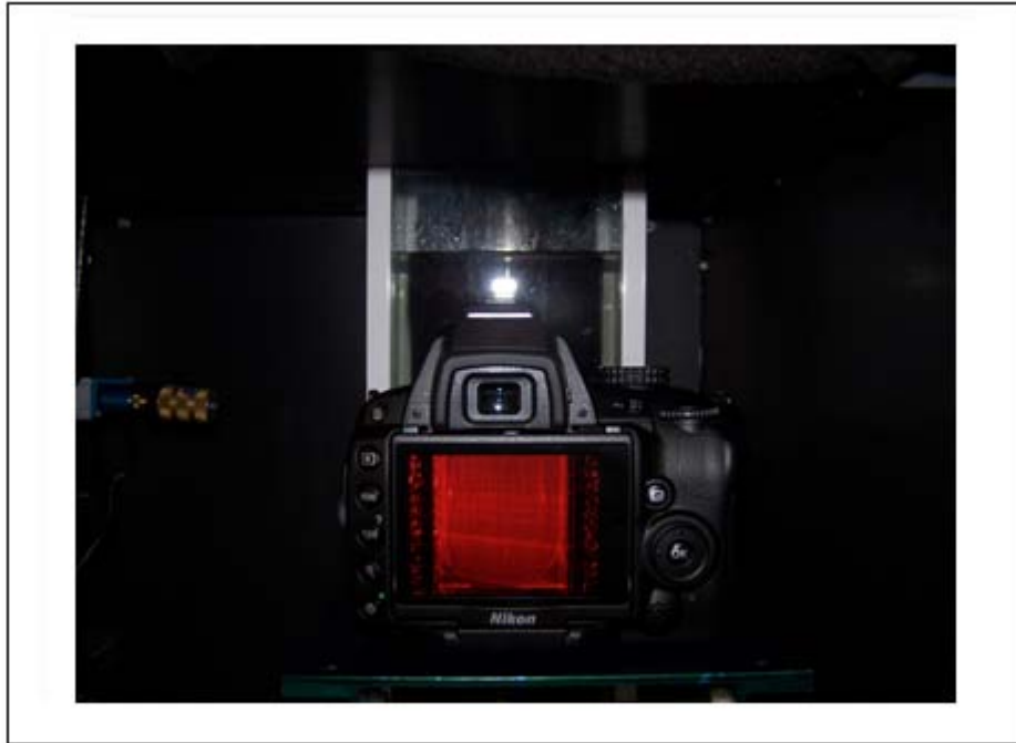
Fig. 2.9-2 Montaje de una cámara oscura para la visualización de vórtices.
