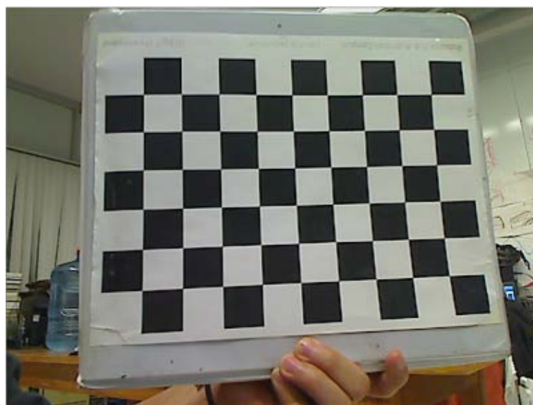
FIGURA 3.1: Patrón de cuadros para calibración de una cámara
