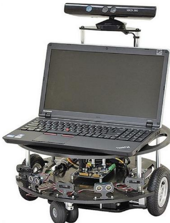
Figura 4.9 Plataforma de un robot Parallax que utiliza una laptop y un sistema embebido
