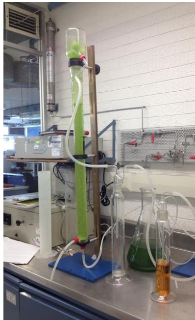
Figura 11. Experimento de la cosecha de biomasa por ozoflotación
