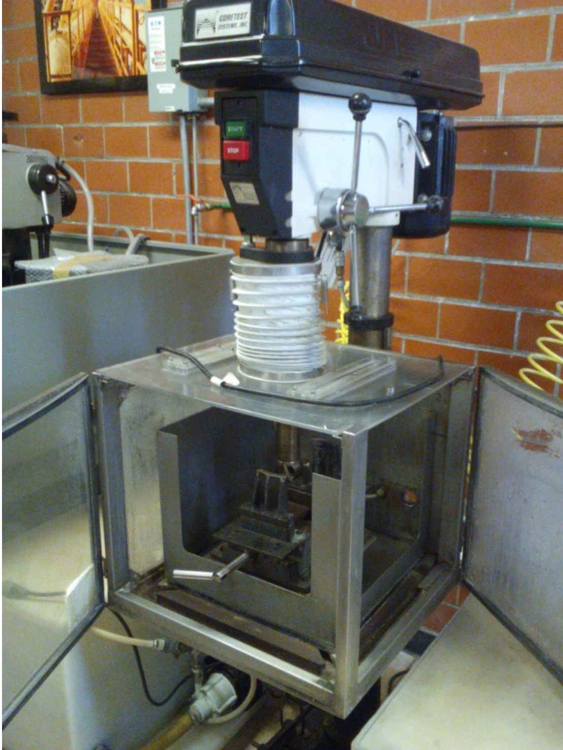
Figura 4.12. Cortadora de tapones del laboratorio de mecánica de rocas del IMP.
