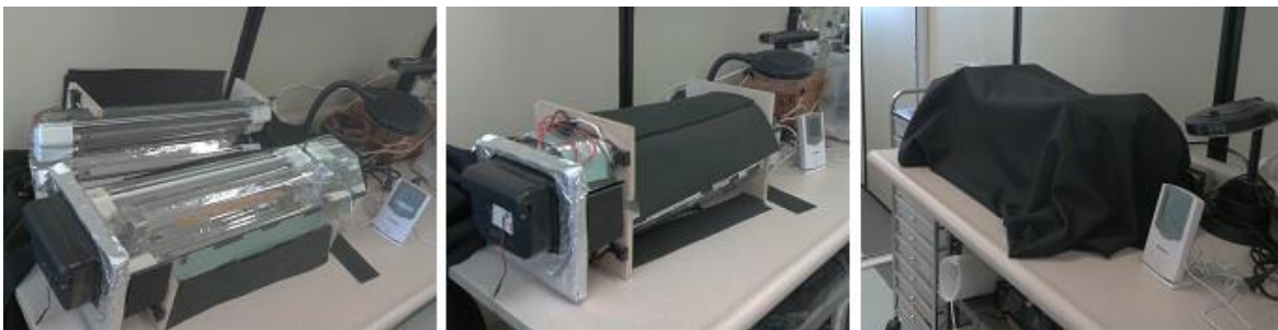
Figura 12. Tratamiento de los granos de maíz palomero en el prototipo radiador.
