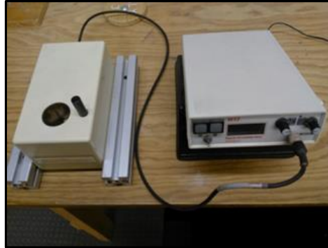
Figura 41 Figura 45. Equipo MS2 (Bartington Instruments Ltd.)
