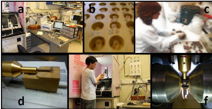
Figura 39. Procesamiento y medición de muestras en Micromag. a) Equipo, b) porta muestras, c) molienda y preparación de muestras. d) porta muestra, e) colocación de las muestras, f) muestra en equipo para su medición.
