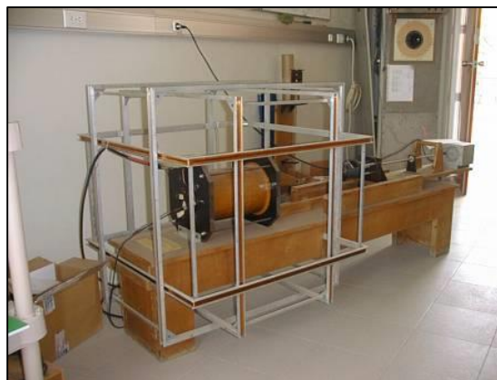
Figura 42. Desmagnetizador de campos alternos de alto voltaje, con bobinas Helmholtz, capaz de alcanzar inducciones de hasta 3 Tesla.
