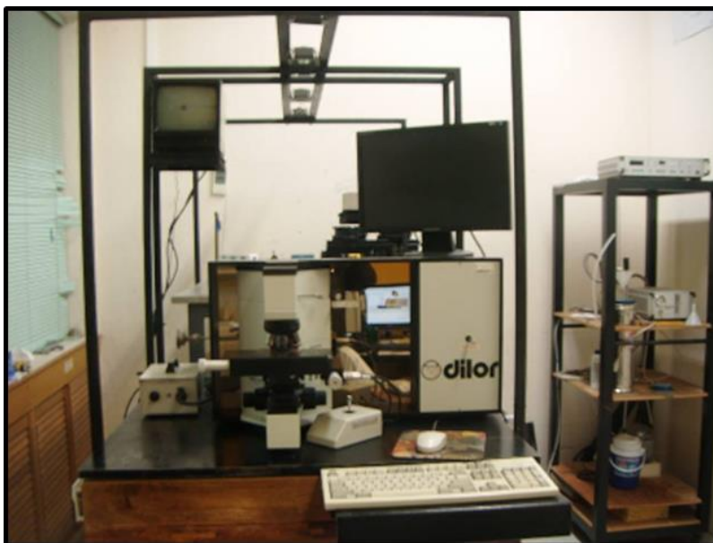
Figura 13. Espectrómetro de RAMAN ubicado en el laboratorio de propiedades ópticas en CINVESTAV, Querétaro.
