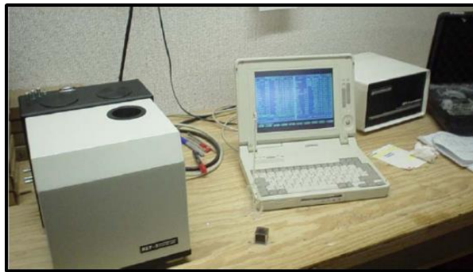
Figura 9. Susceptibilímetro KLY3 (Laboratorio de paleomagnetismo CGEO, UNAM).
