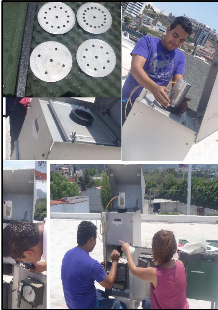
Figura 25. Calibración equipo Hi-vol en el C.W.
