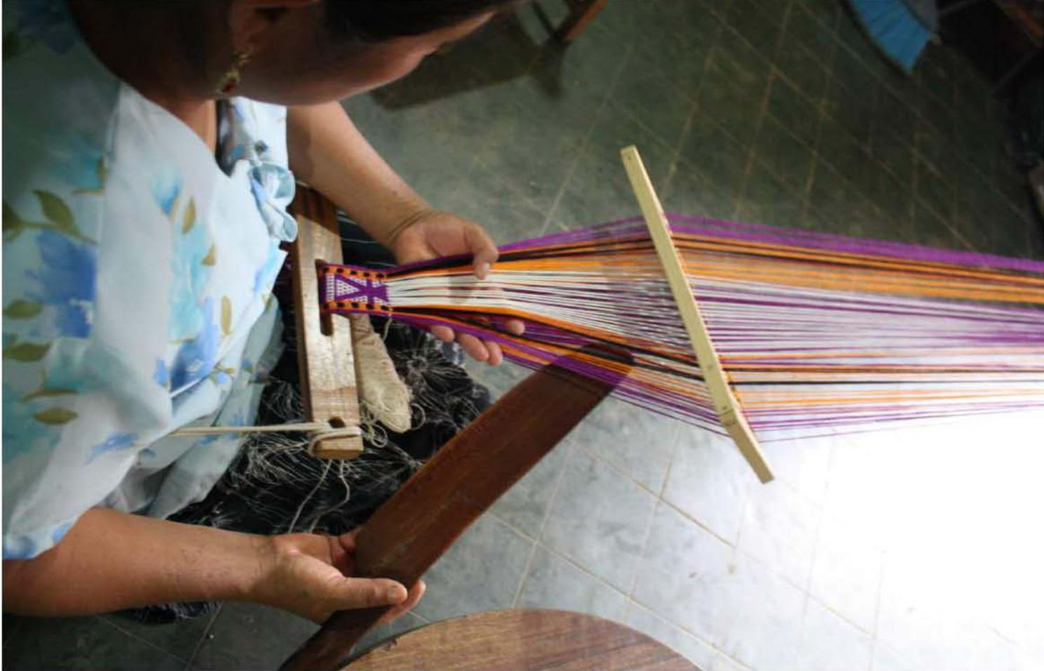
Machete, instrumento de madera para apretar los hilos de la trama y abrir los calados.
