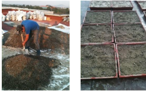
Fig.: 7 y 8 Concentración de 80% de jales y 20% de mezcla testigo Fuente: Contreras López C. (2015)
