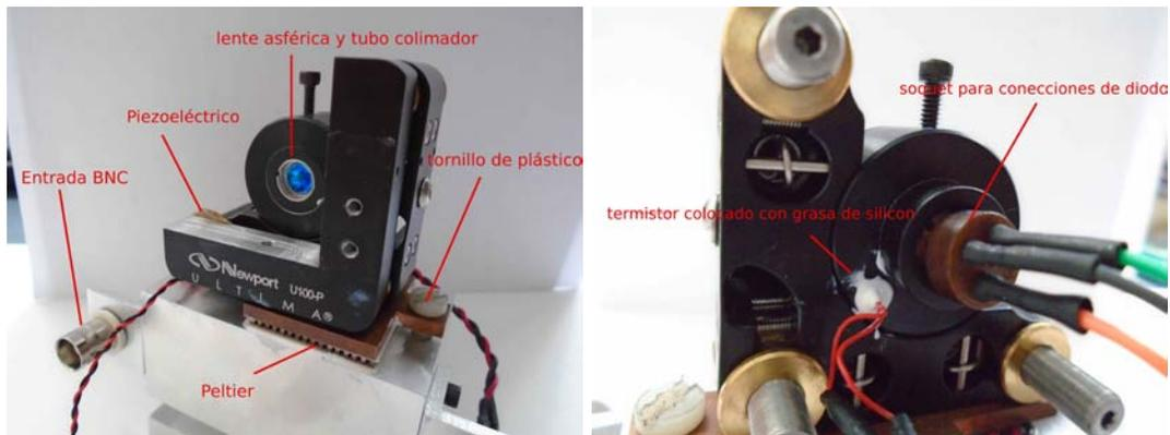
(a) Sistema mecánico-óptico sobre la base de aluminio (b) Termistor y soquet *S8058* colocados respectivamente en la montura UPA-API y el diodo
