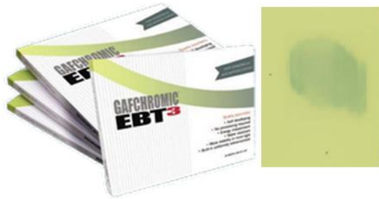
Figura 3.2. Película de tinte radiocrómico Gafchromic® EBT3. Imagen tomada de [14].
