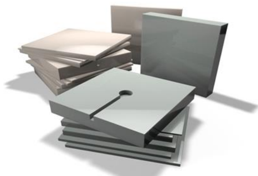
Figura 3.4. Maniquí de agua sólida Plastic Water® CIRS PCW500 modelo PW utilizado para la calibración e irradiación de las películas radiocrómicas.
