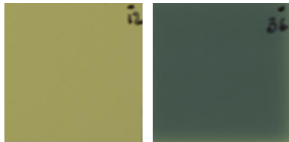
Figura 3.5. Películas radiocrómicas EBT3 con un tamaño de 3 cm × 3 cm. a) Película radiocrómica sin irradiar (fondo). b) Película radiocrómica después de haber sido irradiada.
