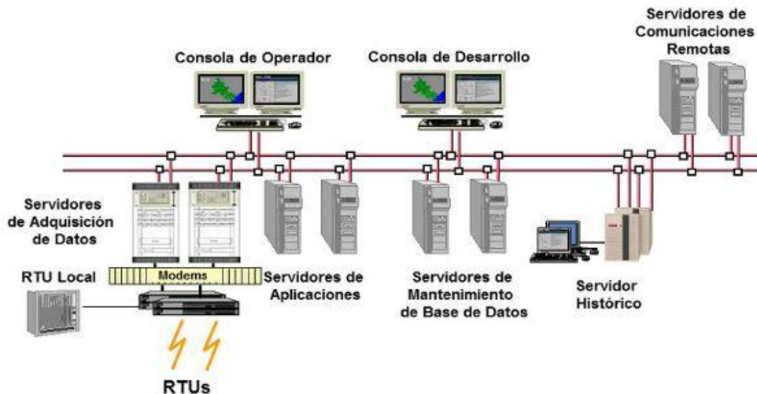
Figura 11 Diagrama de Sistema EMS
