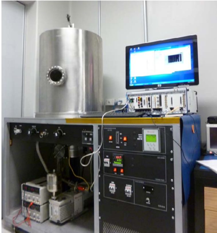
Fig. 5.17. Cámara de vacío y sistema de adquisición de datos del ICN.
