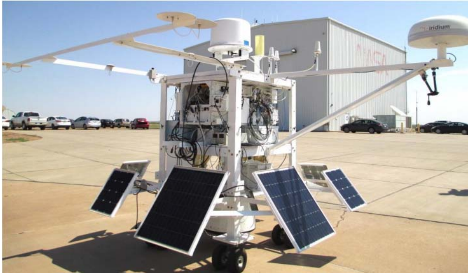
Fig. 1.1. Góndola de la NASA en donde fue montado Pixqui.
