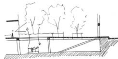
Estudio de programa de laboratorio en sótano con rampa de acceso para carga y descarga de materiales y sistema de ventilación e iluminación natural.
