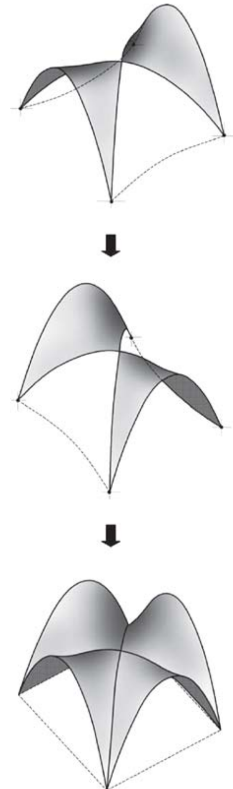
Secuencia de la solución geométrica de la bóveda por arista resuelta con intersección de dos hypars del tipo "silla de montar". Dibujo: Moisés Escárcega, UNAM, tomado del libro Las estructuras de Candela de Colin Faber, p. 150
