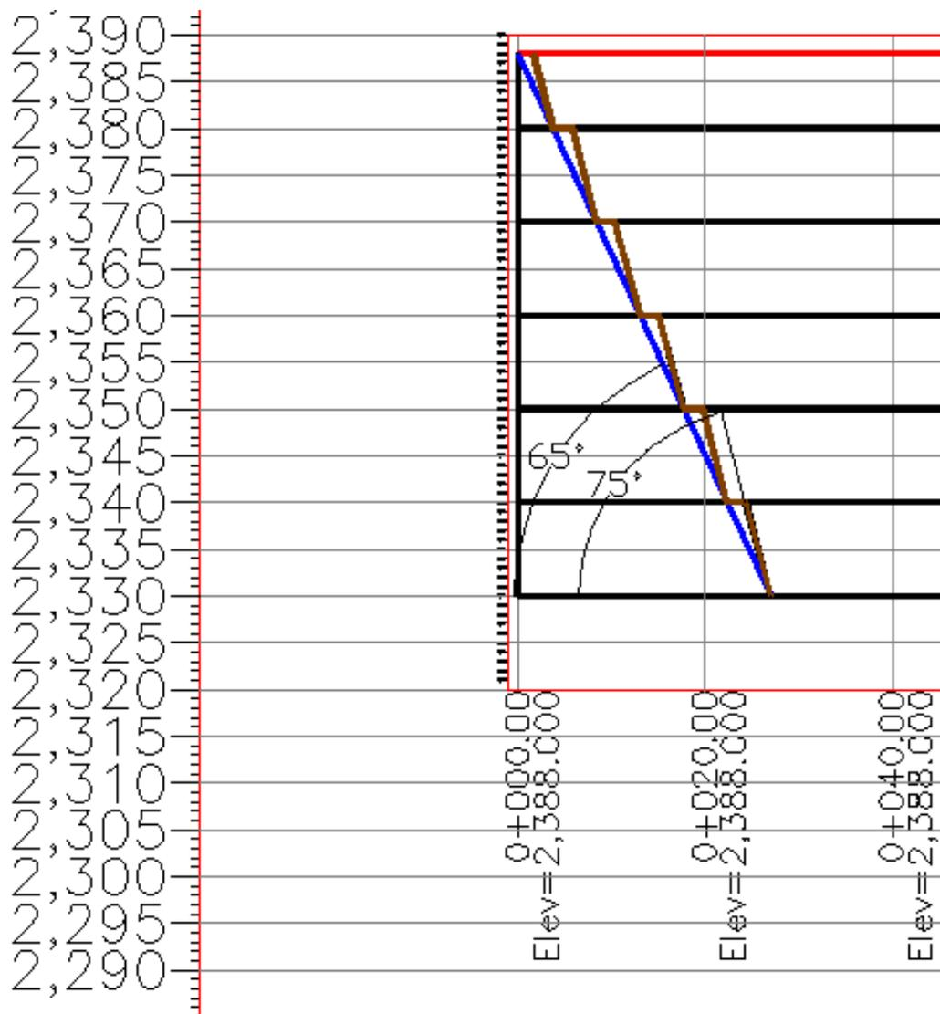
Figura 5.7 Detalle del talud final propuesto
