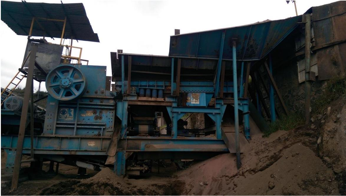
Figura 4.8 Zona de trituración y clasificación primaria
