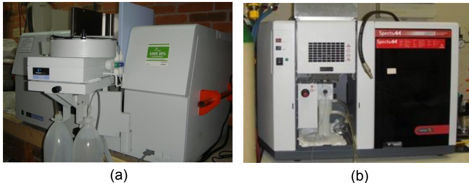
Figura 8. (a) Espectrofotómetro de absorción atómica (EAA) con sistema de corrección por efecto Zeeman acoplado con horno de grafito (AAAnalyst 800, Perkin-Elmer); (b) EAA SpectraAA 220 (VARIAN VGA-110)
