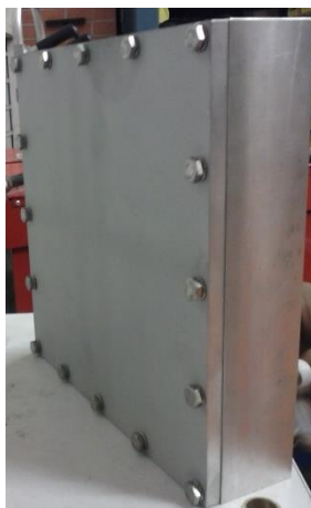
FIGURA 3-13 SUPERFICIE TRATADA CON SANDBLASTING.
