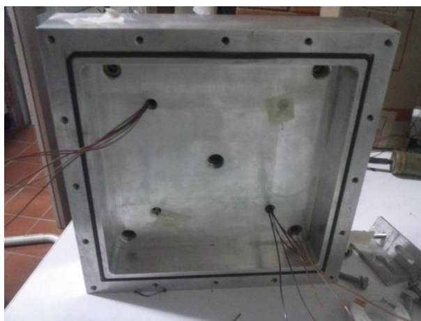
FIGURA 3-8 POZOS TÉRMICOS DENTRO DE LA CAVIDAD DEL RECEPTOR.
