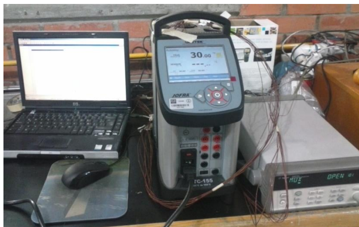
FIGURA 3-5 CALIBRACIÓN DE TERMOPARES CON UN POZO TÉRMICO.
