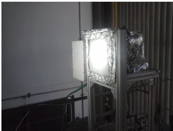
FIGURA 3-1 RECEPTOR CALORIMÉTRICO A ESCALA PARA EVALUACIÓN EN EL HoSIER.
