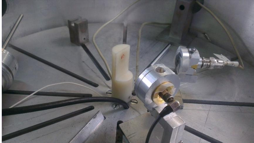
Figura 16. Muestra el arreglo experimental una vez que el haz de deuterio ha sido alineado, también se observa el cátodo de Cobre.
