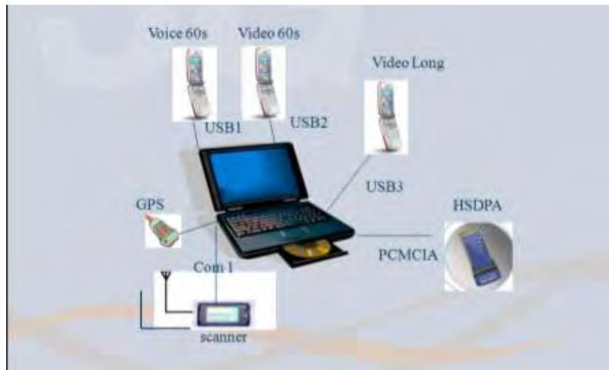
**Figura 3.42 Equipo y conexión**
