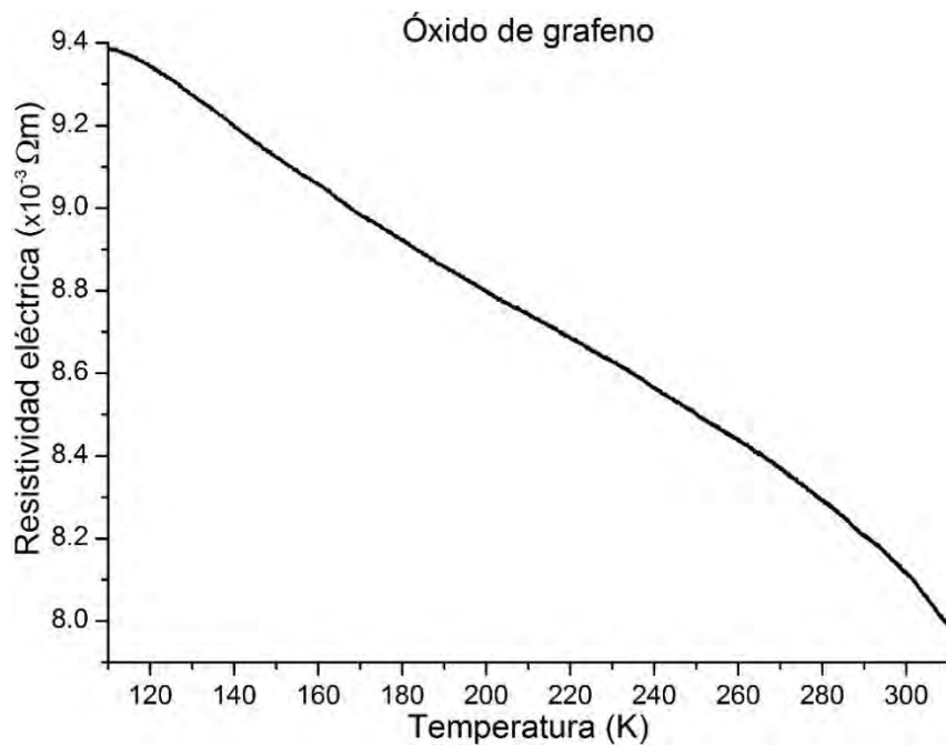
Figura 5.11. Resistividad en función de la temperatura para el óxido de grafeno.
