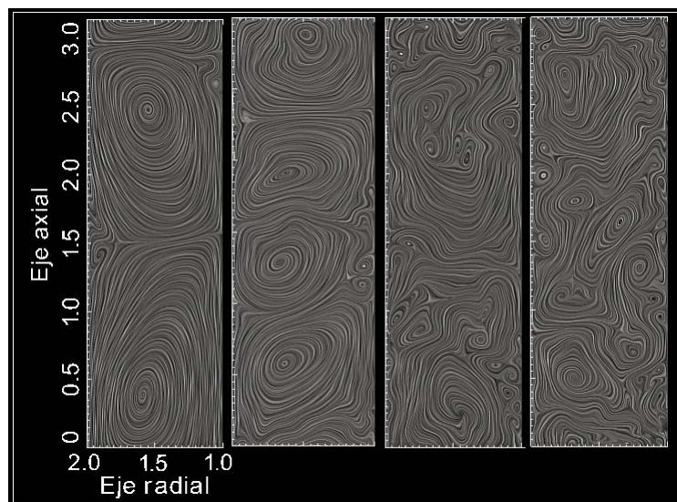
Figura 5.2: Campos de velocidad radial instantáneo en un plano radial-axial para Re=1000 , 3000 , 5000 y 8000 , de arriba a abajo respectivamente
