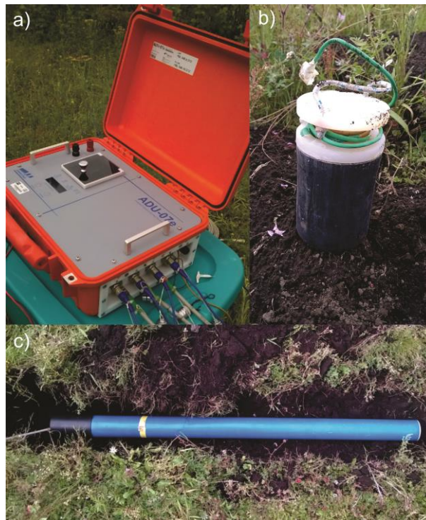
Figura 5.3 Equipo utilizado en los sondeos magnetotelúricos a) Sistema de adquisición de datos Metronix ADU-07 b) Electrodo (EFP-06) de terreno de banda ancha, de tipo Pb/PbCl 2 , c) Bobina de inducción magnética (MFS-06e).
