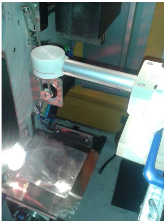
Figura 3.13: Montaje experimental para medir CHR. La cámara de ionización está colocada sobre placas de acrílico montadas en un soporte universal. El tubo de rayos X se encuentra por debajo de la cámara de ionización; se observan los filtros de aluminio encima del tubo de rayos X.
