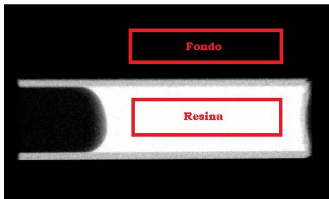
Figura 3.3: Colocación de la ROI para medir el VMP de la resina y del fondo en esta etapa del estudio.
