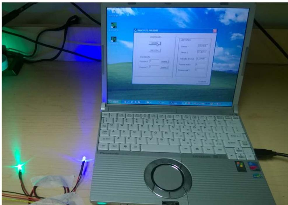
Figura 3.10. LEDs de bomba y válvula encendidos.
