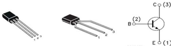
Figura 1.14. A) Diagrama de conexión B) Diagrama interno.
