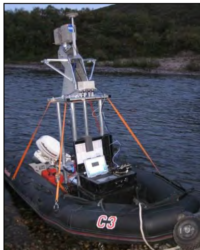
Fig. 10. Escáner montado en lancha para el mapeo de procesos fluviales (Kukko, 2013).
