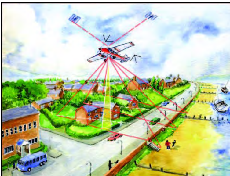
Fig. 9. Principio de funcionamiento del LIDAR aerotransportado (Heritage and Large, 2009).
