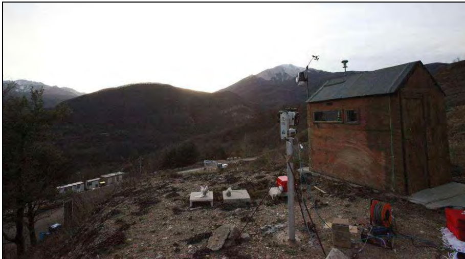
Fig. 30. Fotografía de una estación maestra de un sistema de monitoreo. Se muestra un TLS de largo alcance (Bertacchini, 2012).
