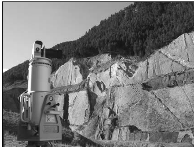
Fig. 8. Ejemplo de un escáner terrestre Riegl LMSZ420i (Hodgetts, 2009).
