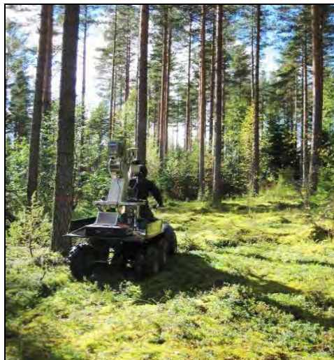
Fig. 11. Escáner montado en vehículo todo terreno con exploración vertical (Kukko, 2013).
