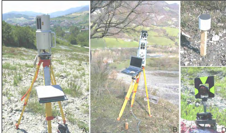
Fig. 44. Instrumentos adaptados para los estudios de escaneo láser: A) Riegl LMS-Z210; B) Riegl LMS-Z420i; C) Retroreflector cilíndrico; D) Retroreflector de prisma (Bitelli, 2002).
