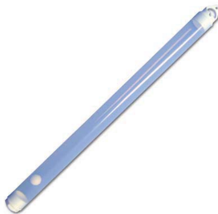
Figura 3.2: Botella usada para la obtención de las muestras de agua.
