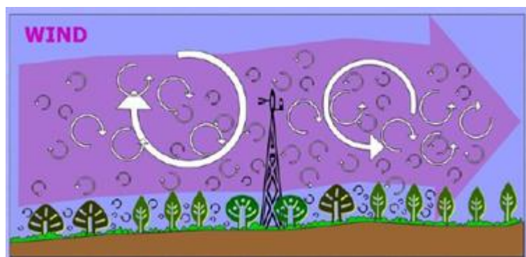
Figura 2. Flujo atmosférico turbulento. Los remolinos turbulentos se encuentran embebidos dentro del flujo horizontal de aire.
