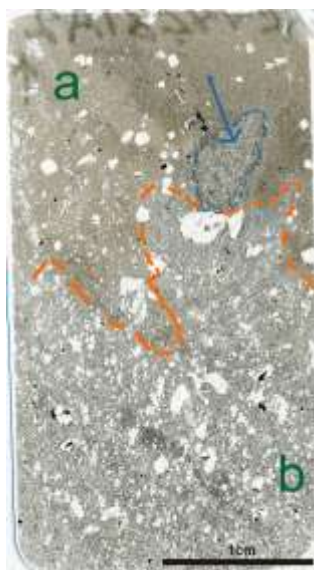
Figura 21. Imagen escaneada de lamina delgada, de un corte a través de la corteza vítrea (café claro en lamina) y el núcleo gris vesicular de una bomba (muestra ZAC-14281A2, ver Fig.4 y detalles en tabla 1, apéndice 2)
