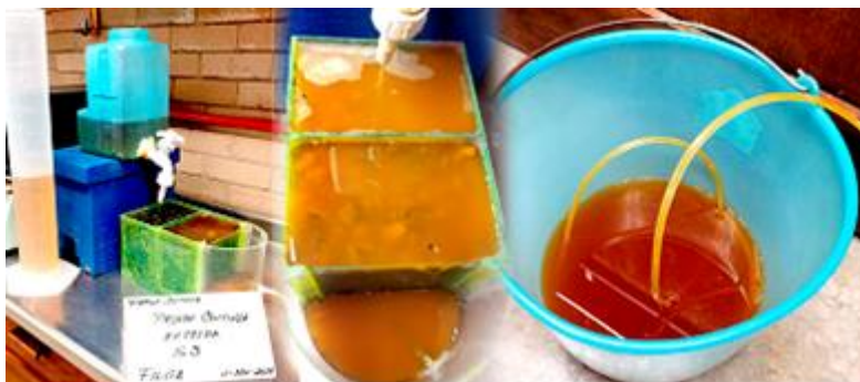
Figura 21. Recirculación de DA a través de la celda empacada con roca filita y su posterior recuperación
