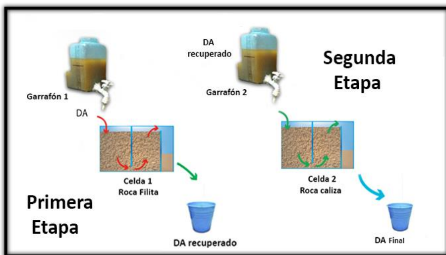
Figura 22. Procedimiento que se siguió para la adición del DA
