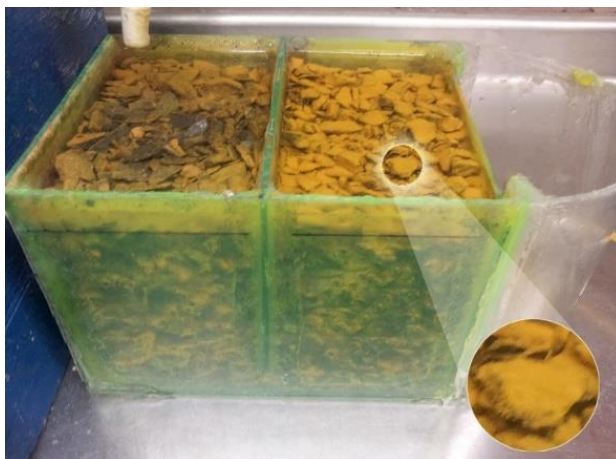
Figura 32. Formación del precipitado de oxihidróxidos de hierro durante la prueba
