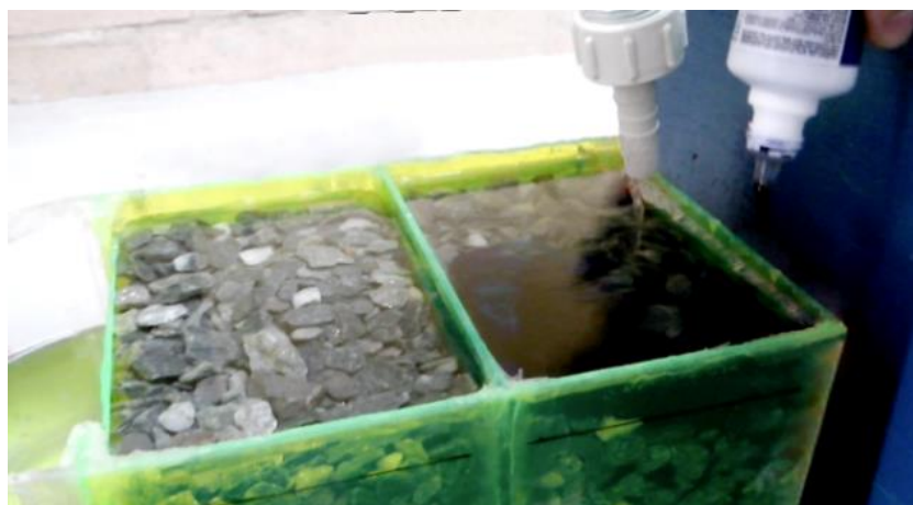
Figura 15. Adición de trazador en la celda de tratamiento
