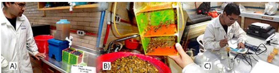
Figura 18. A) Inicio de la primera etapa, B) DA eliminado en cada ciclo, C) Medición de valores de la muestra en cada ciclo
