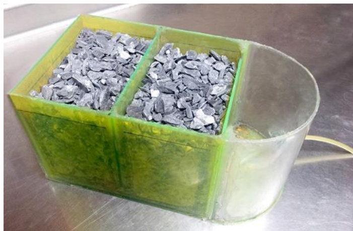
Figura 12. Celda de tratamiento rellena con roca filita
