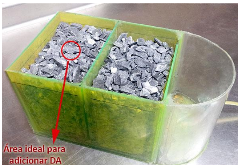
Figura 29. Celda de tratamiento empacada con roca filita
