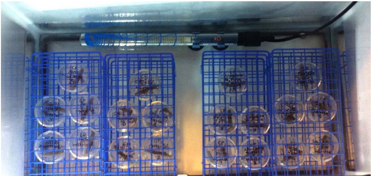
Imagen 5. Vista desde arriba del recipiente de vidrio con todos los grupos de muestras sumergidas en sus respectivas gradillas.
