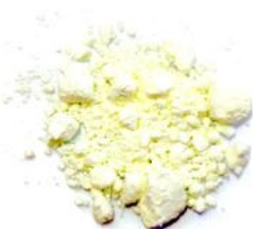
**Fig. 5.1a.** Xantato isopropil de potasio.  $C_3$ . (KIPX)
