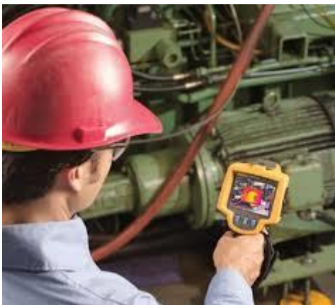
Figura 3-1 La implementación de un Programa de Mantenimiento con Termografía Infrarrojo.
