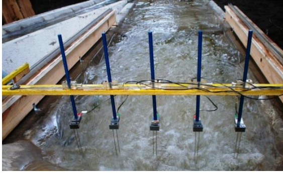
Figura 23. Sondas medidoras del nivel de agua.
