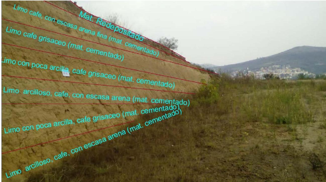
FIGURA 24. PERFIL ESTRATIGRÁFICO TALUD – 4
