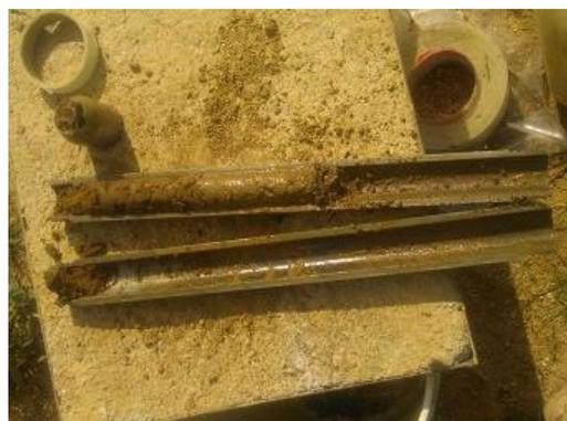
FOTOS DE LA EJECUCIÓN DE UN SONDEO PROFUNDO Y DE UNA DE LAS MUESTRAS ALTERADAS OBTENIDAS DEL MISMO
