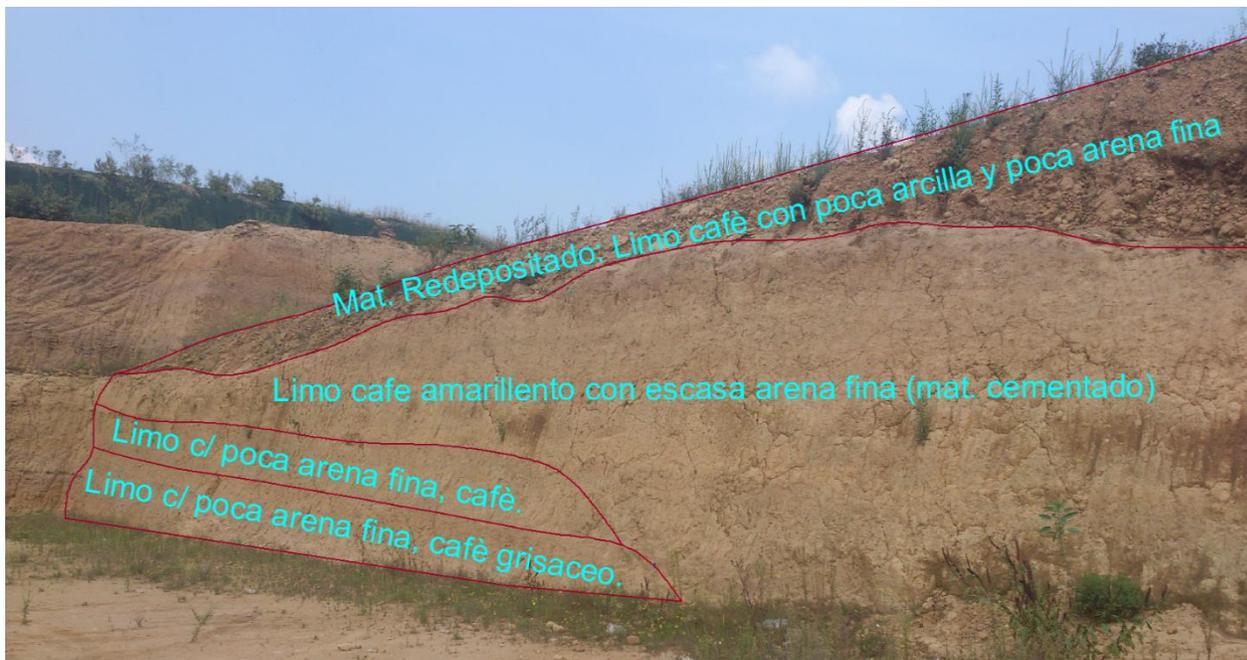
**FIGURA 21. PERFIL ESTRATIGRÁFICO TALUD - 1**
