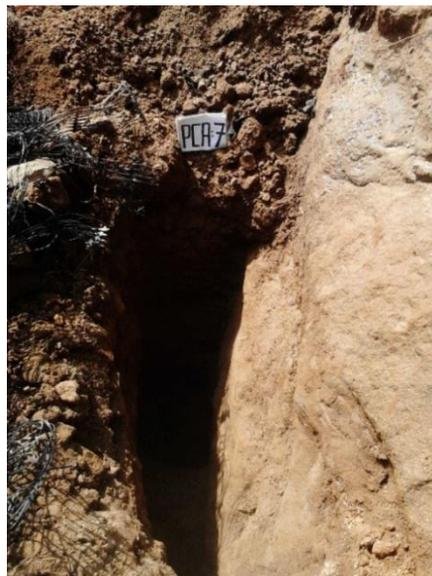
FIGURA 16. PERFIL ESTRATIGRÁFICO PCA – 7
