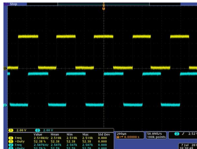
Figura 3.3. Señales digitales a la salida del encoder cuando el eje del motor está girando, alimentación del encoder = 5V. Cortesía de Pololu [15].
