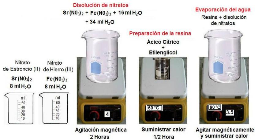
Figura (2.4). Esquema de la síntesis por Pechini para la hexaferrita  $\text{SrFe}_{12}\text{O}_{19}$ .
