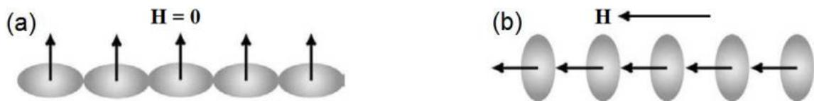
Figura (A1.12). Arreglo de espines alineados a lo largo del: (a) eje fácil, (b) campo externo aplicado.
