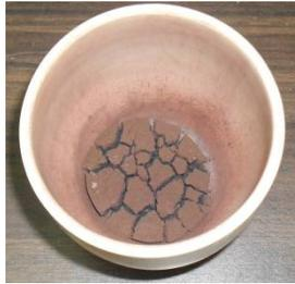
Figura (3.1.7). Polvo de hexaferrita  $\text{SrFe}_{12}\text{O}_{19}$ .
