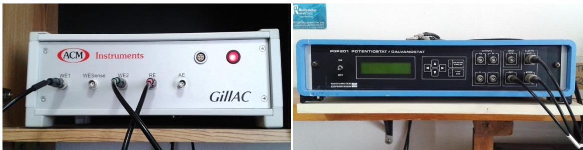
Figura 3.10 – (a) Equipo ACM Instruments Gill AC usado para los ensayos de REQ y EIS. (b) Potenciostato/galvanostato Radiometer PGP 201, usado para la Voltamperometría.
