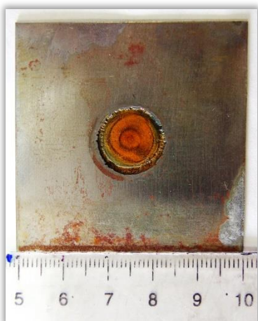
Figura 4.31 – Figura de la marca de corrosión del acero sin recubrimientos.
