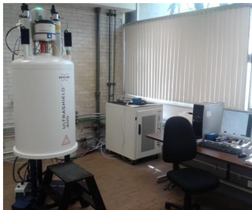
Figura 19. Equipo Bruker Modelo Avance III de 9.4 Teslas (400 MHz para ^1\text{H} ).
