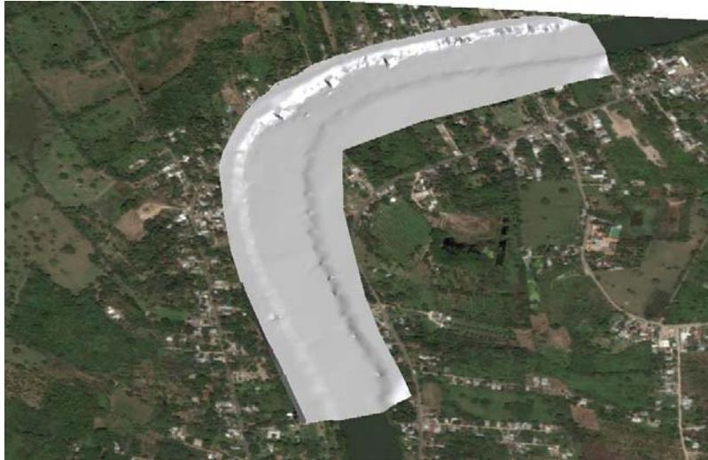
Figura 4.2.4 Superficie con las elevaciones topobatemétricas para análisis hidrodinámico.
