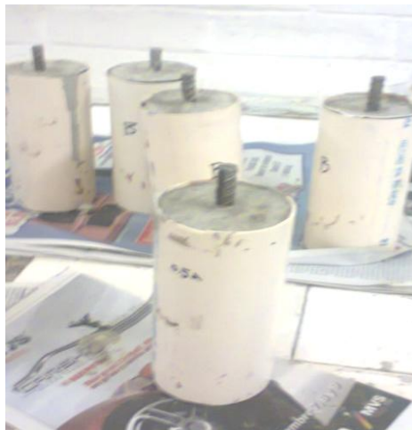
Figura 3.2 Probetas después del vaciado de la mezcla
