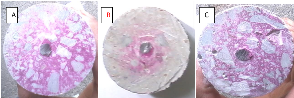
FIGURA 4.1 Muestra el cambio de coloración en las secciones que fueron cortadas las probetas, estas corresponden a la probeta I y II (inmersas en solución salina)
