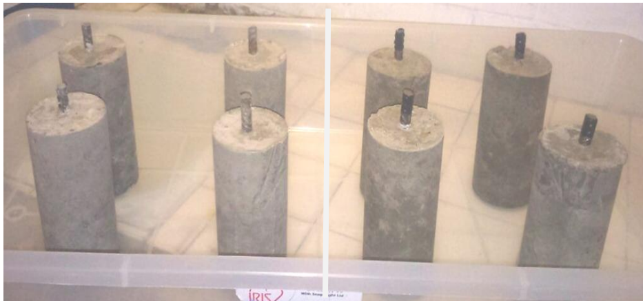
Figura 3.4 Probetas antes de ser sometidas al curado. Las 4 de la izquierda corresponden a una relación a/c de 0.63, las 4 de la derecha tienen una relación a/c de 0.59
