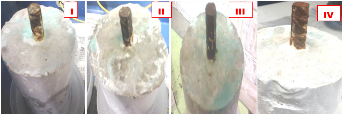
FIGURA 4.5 Deterioro de las varillas de refuerzo a los 150 ciclos de ensayo, con humedad y temperatura.
