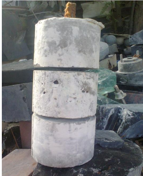
Figura 3.10 Vista final de las probetas después de cortarlas con el esmeril
