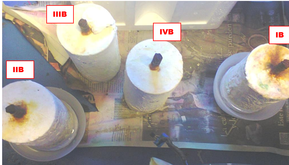
FIGURA 4.8 Probetas del grupo 2, con alrededor de 170 ciclos de ensayo de corrosión acelerada.
