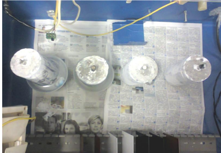
Figura 3.6 Acomodo de las probetas dentro de la cámara para ensayos acelerados de corrosión.
