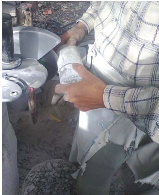
Figura 3.9 Muestra cómo se realizó el corte seccional a cada probeta
