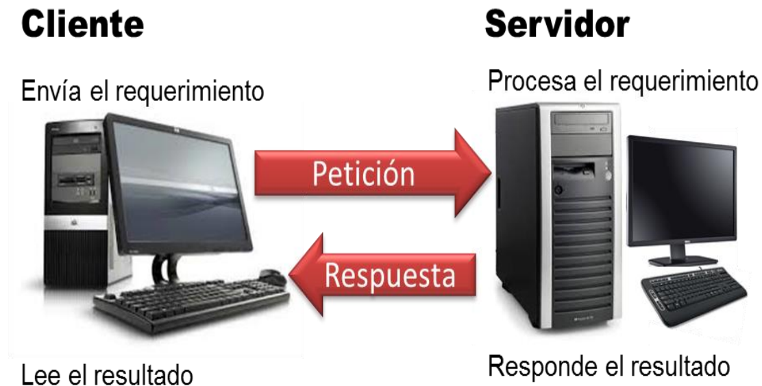
Figura 2.4.1 Arquitectura básica Cliente-Servidor
