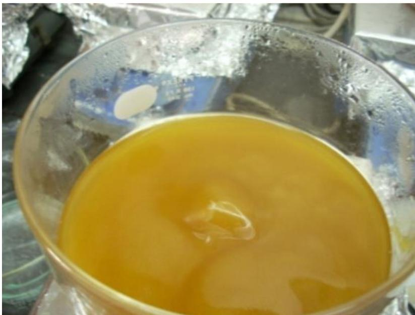
*Figura 4.2.1.1: Gel de  $\text{V}_2\text{O}_5$*
