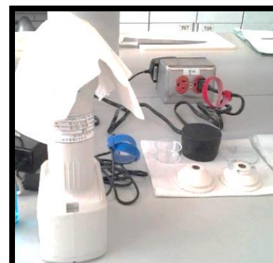
Figura 21. Espectrofotómetro de reflectancia Konica Minolta CM600d
