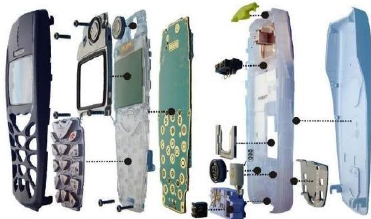
**Figura 1. Celular mediante ingeniería inversa.**
