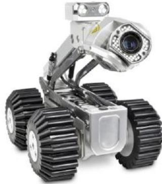
**Figura 15. Robot Rodante de inspección.**
